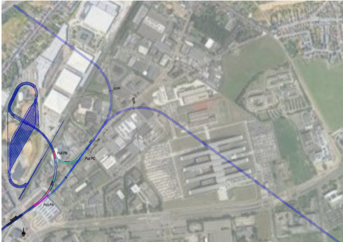
Figuur 262: Indicatief schema van de toegangskegel van de tunnelboormachine vanuit een verlengingskunstwerk onder de décaathlon (BMN 2021)
