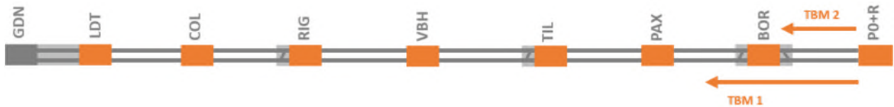
Figuur 205: Voorgang van de bouw met de tunnelboormachine (BMN, 2020)
