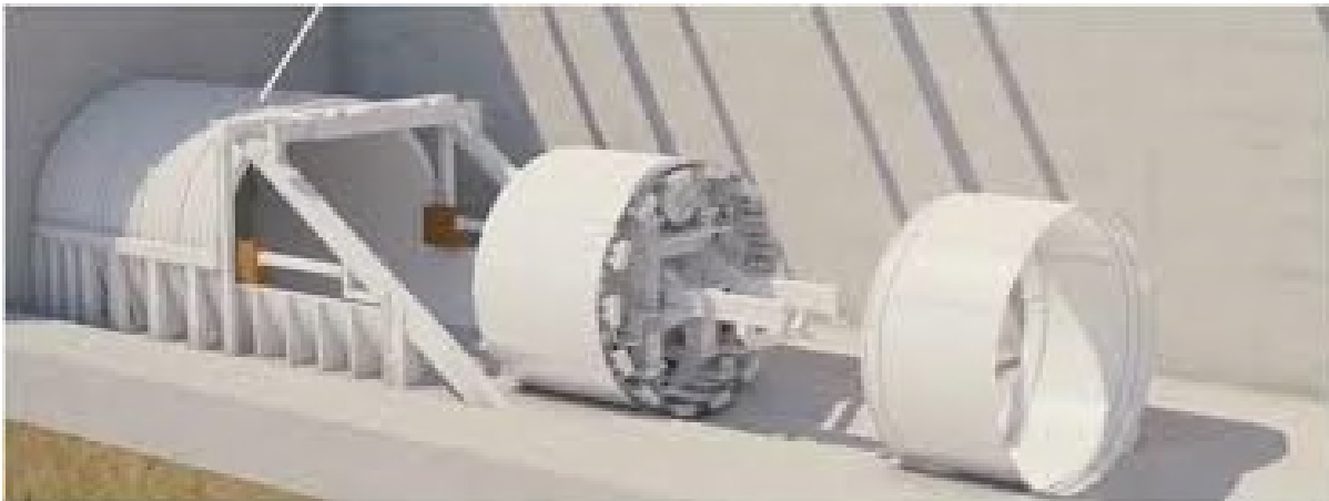
Figuur 5: Illustratie van een startstolp van een tunnelboormachine (Le Grand Paris Express, 2019)
