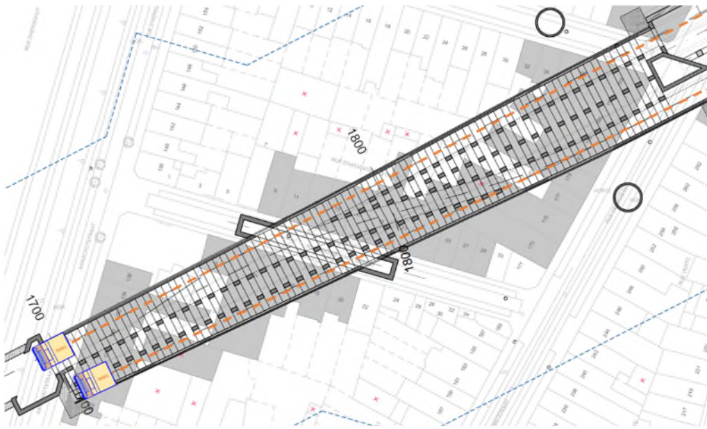
Figuur 185: Variant 2: Verlenging van de tunnelboormachines tot aan schacht P5 (BMN, 2020)
