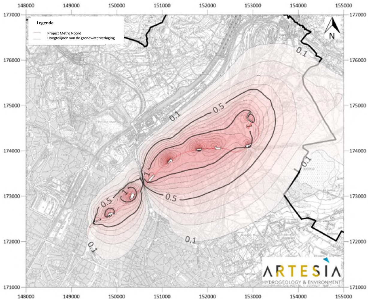
Figuur 77: Impact van de permanente drainering van de tunnel en de stations op het piëzometrische niveau - kaart van de verlagingen van de grondwaterspiegel (V1) (Artesia, 2020)
