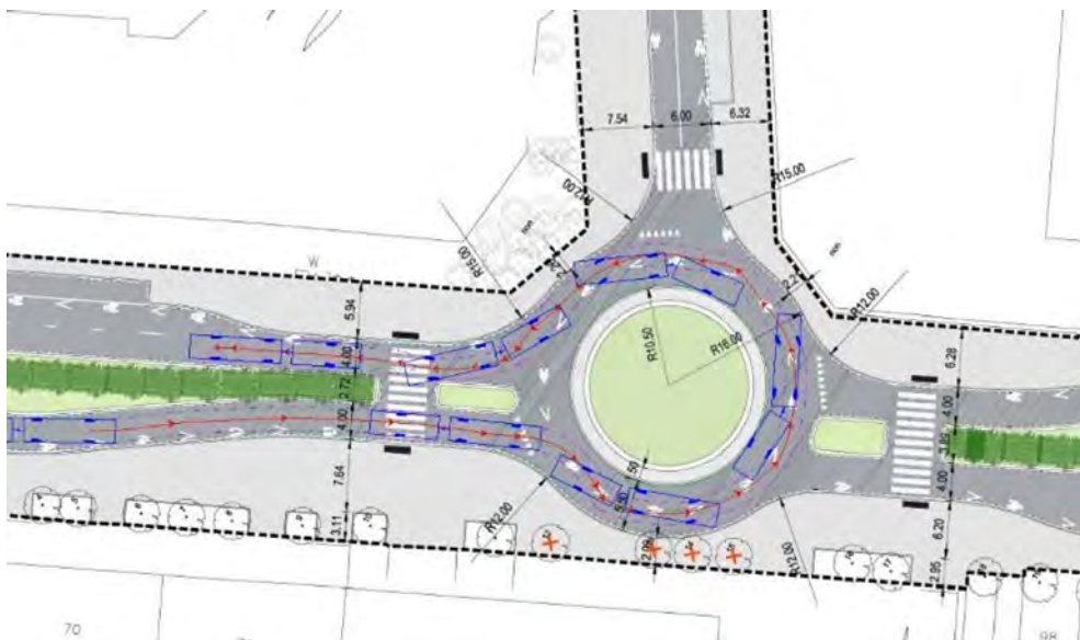
Figuur 74: Draaiproef gelede bus op rotonde Bordet/Schiphol - AutoTURN © (ARIES, 2020)
