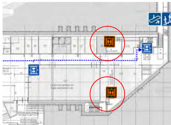
Figuur 88: Wijziging van het gebruik van de liften op het perronniveau van het station om PBM vanaf dit niveau toegang te geven tot de metroperrons (ARIES, 2020)
