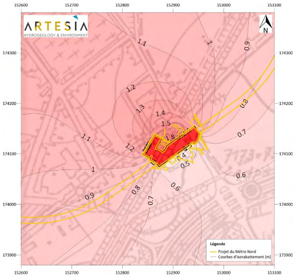
Figure 167 : Impact du drainage permanent de la station sur le niveau piézométrique environnant (Artesia, 2020)
