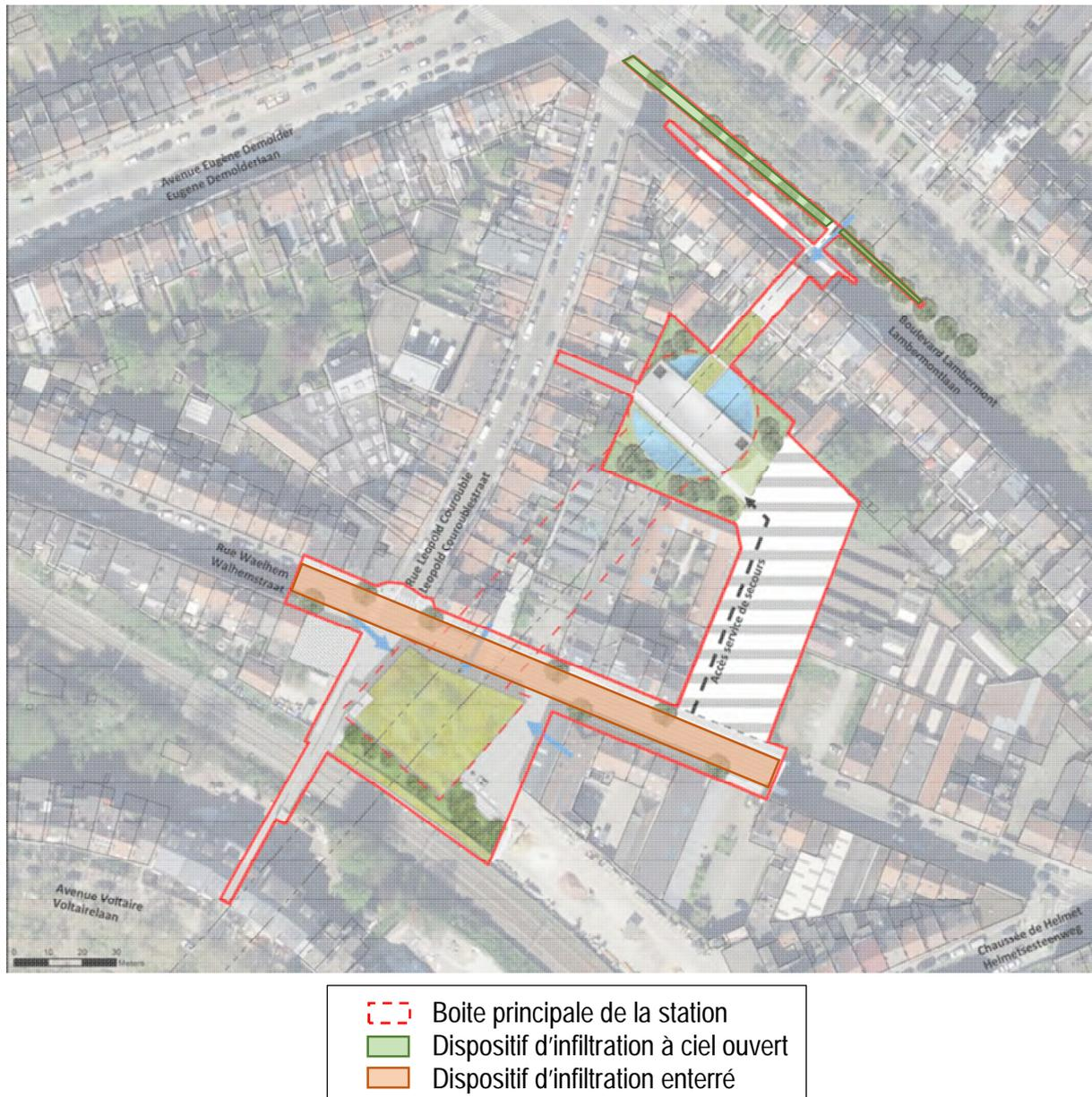
**Figure 205 : Localisation de zones où l'aménagement d'un dispositif d'infiltration serait optimal (ARIES, 2020)**
