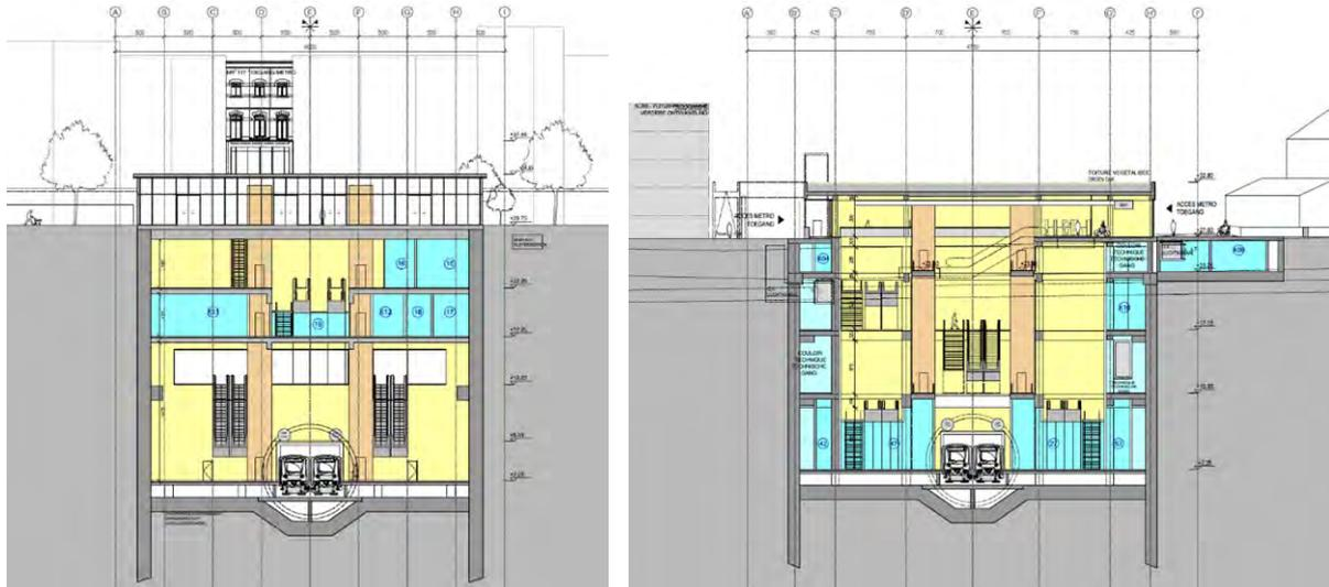
Figure 9: Coupes transversales de la station Verboekhoven : pavillon nord (à gauche) et pavillon sud (à droite) (BMN, 2018)
