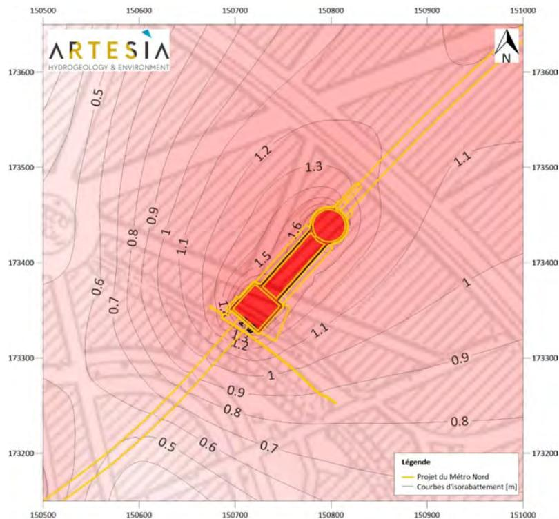
**Figure 191 : Impact du drainage permanent de la station sur le niveau piézométrique environnant, au niveau inférieur de la station (Artesia, 2020)**
