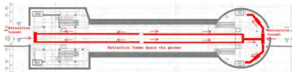
Figure 18 Verboekhoven – Niveau quais - Extraction des fumées des quais
