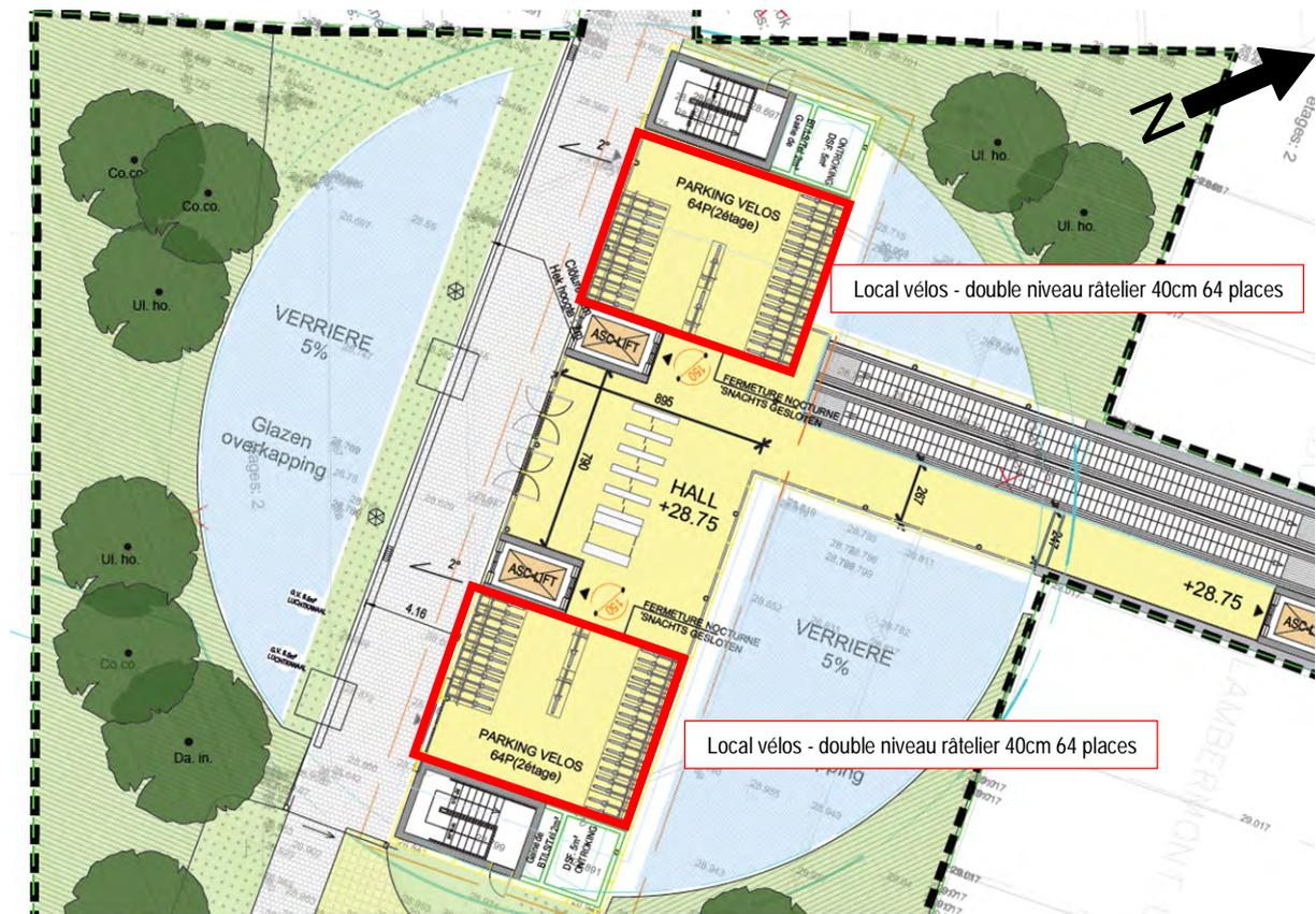
Figure 94 : Localisation et détail du stationnement vélos dans la boîte nord de la station (ARIES, 2020 sur fond BMN 2018)
