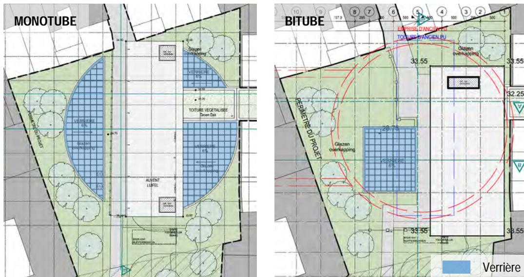
Figure 162 : Comparaison des verrières prévues dans les versions monotube et bitube pour la station Verboekhoven (BMN, 2017 & 2020)
