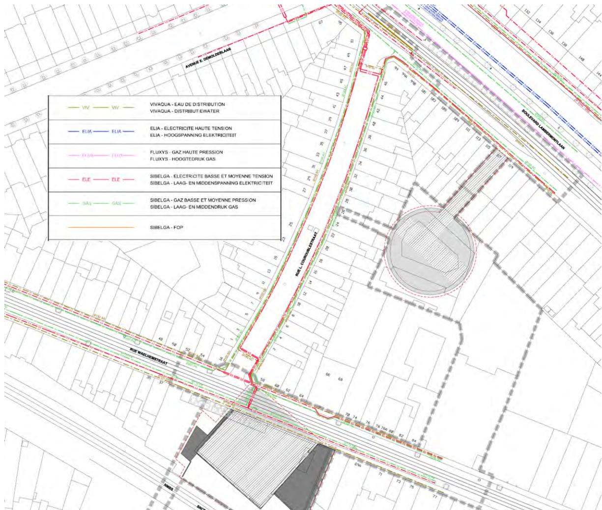
Figure 174 : Localisation des réseaux eau, gaz et électricité (BMN, 2020)
