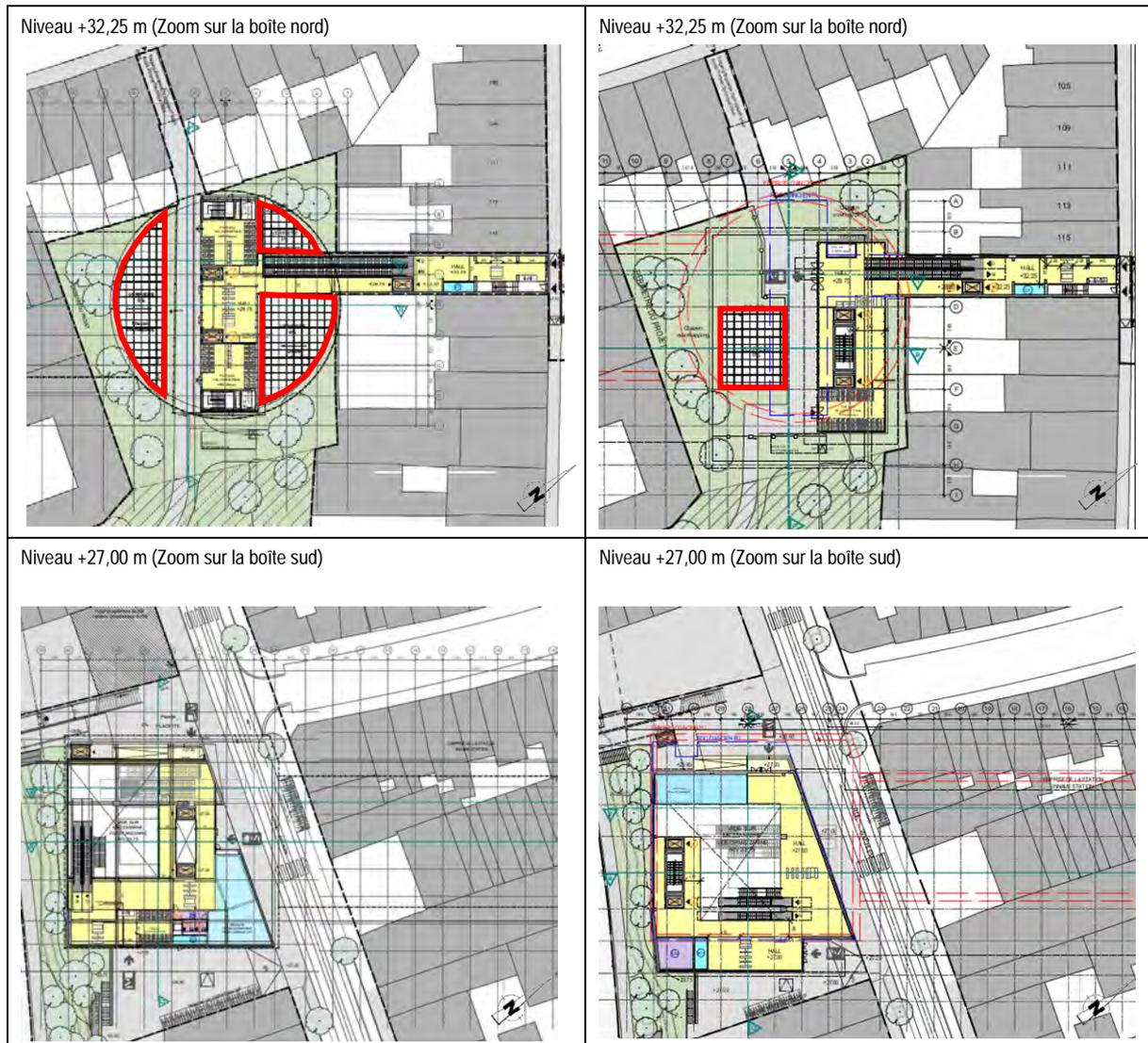
**Tableau 60 : Solution monotube à gauche et alternative bitube à droite – Station Verboekhoven (niveaux +27,00 m et +32,25 m) (BMN, 2017 & 2020)**
