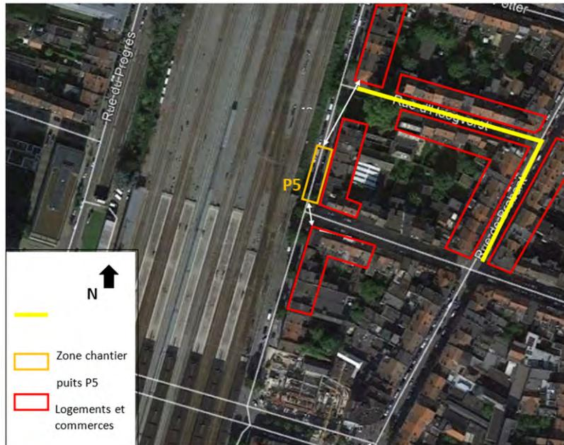
**Figure 136: Localisation des immeubles les plus susceptibles d'être soumis aux bruits et vibrations du chantier du puits P5 (source : Google Earth)**
