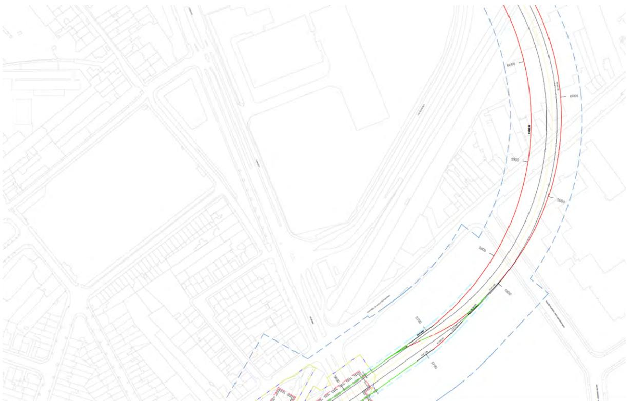
Figure 233 : Zone d'influence de la solution bi-tube vers le dépôt de Haren (ligne tiretée bleu)(BMN, 2020)
