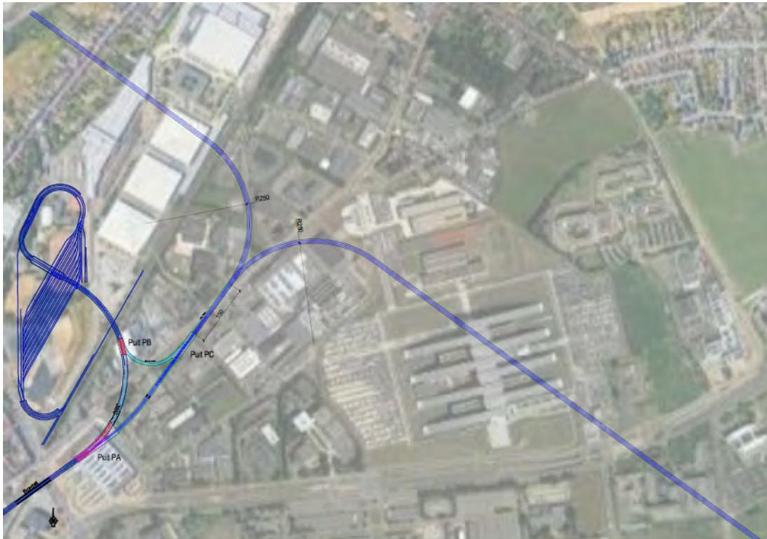
**Figure 262: Schéma indicatif du cône d'accessibilité en tunnelier depuis un ouvrage de prolongement sous le décathlon (BMN 2021)**
