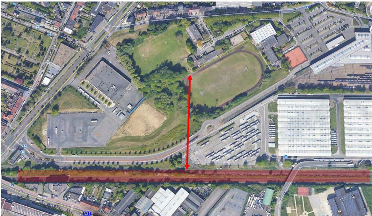
Figure 25: Schéma de principe de l'évacuation des déblais vers la L26 (Aries sur Google Earth consulté en février 2021)
