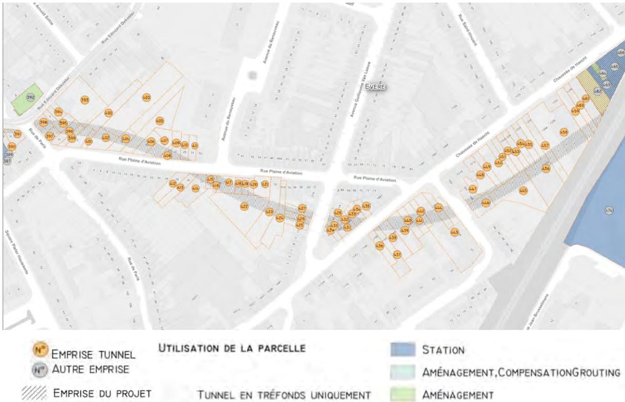
Figure 58 : Illustration des parcelles impactées par la construction du tunnel (BMN, 2020)
