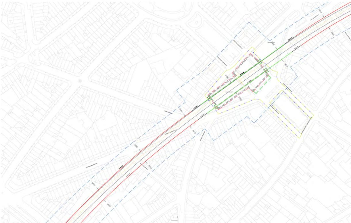
Figure 229 : Zone d'influence de la solution bi-tube au droit de la station Riga (ligne tiretée bleu)(BMN, 2020)
