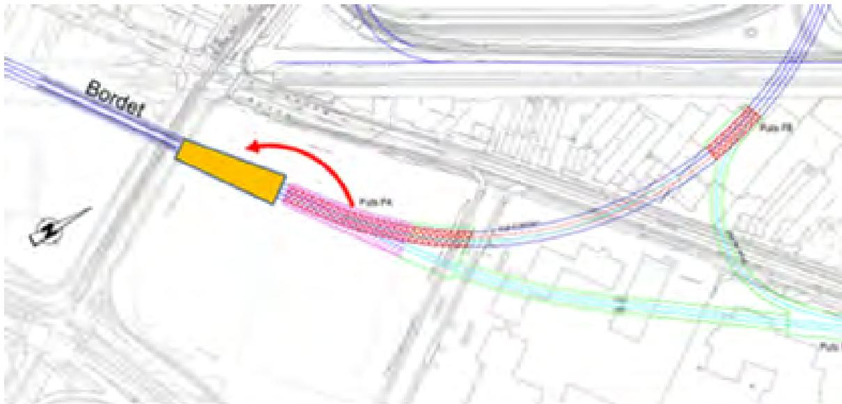
**Figure 256: Schéma de principe de l'ouvrage de prolongement – Option Bordet (source BMN, 2020)**
