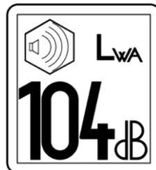
**Figure 138: Pictogramme marquage CE, conforme aux directives européennes 2005/88/CE et 2006/42/CE**
