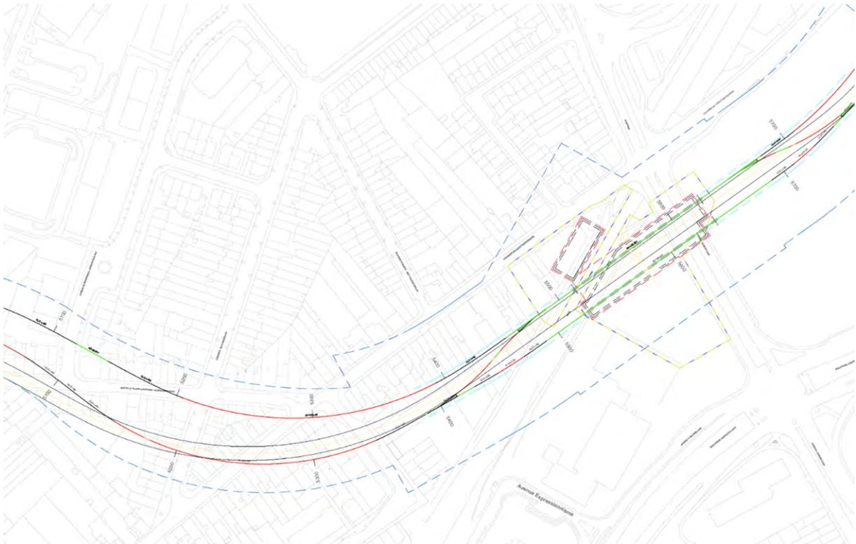
Figure 232 : Zone d'influence de la solution bi-tube au droit de la station Bordet (ligne tiretée bleu)(BMN, 2020)
