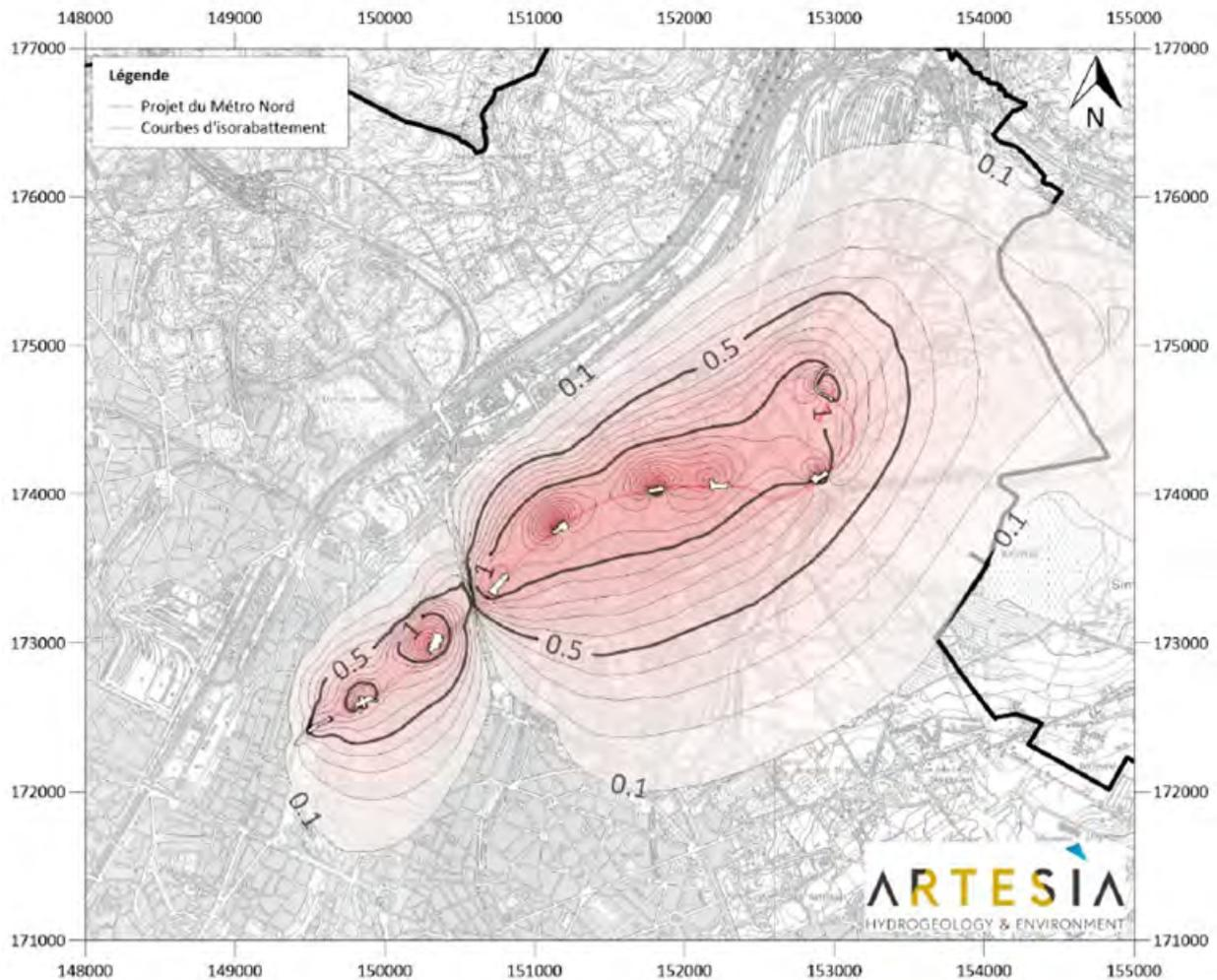
Figure 77 : Impact du drainage permanent du tunnel et des stations sur le niveau piézométrique – carte des rabattements (V1) (Artesia, 2020)
