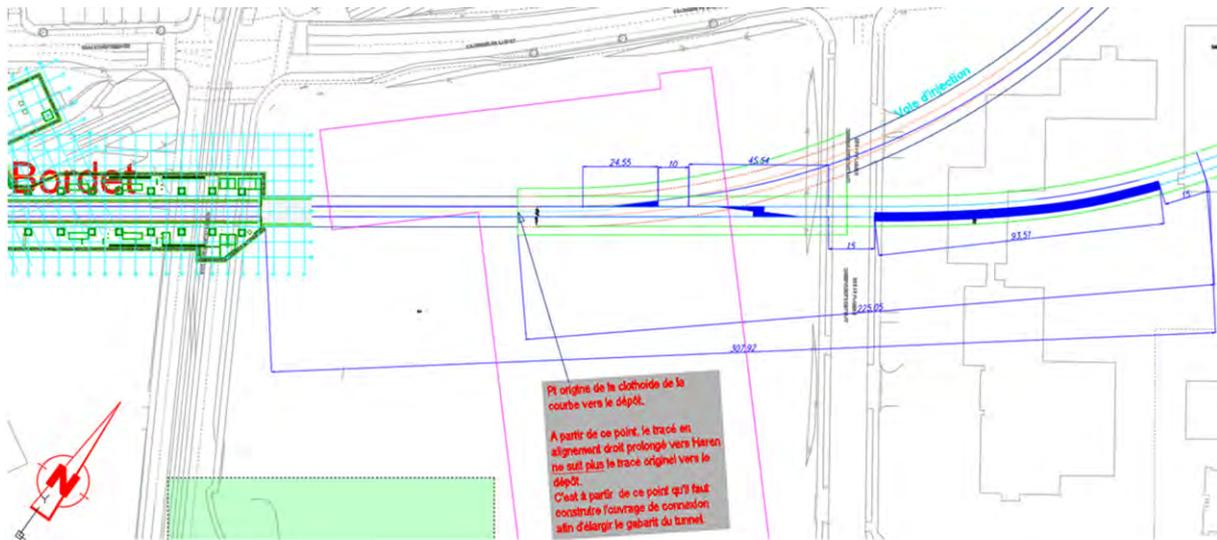
**Figure 258: Schéma de principe de la variante 2 Bordet avec un ouvrage d'aiguillage et de retournement sur 275m depuis la sortie de quais à Bordet (source BMN, 2020)**
